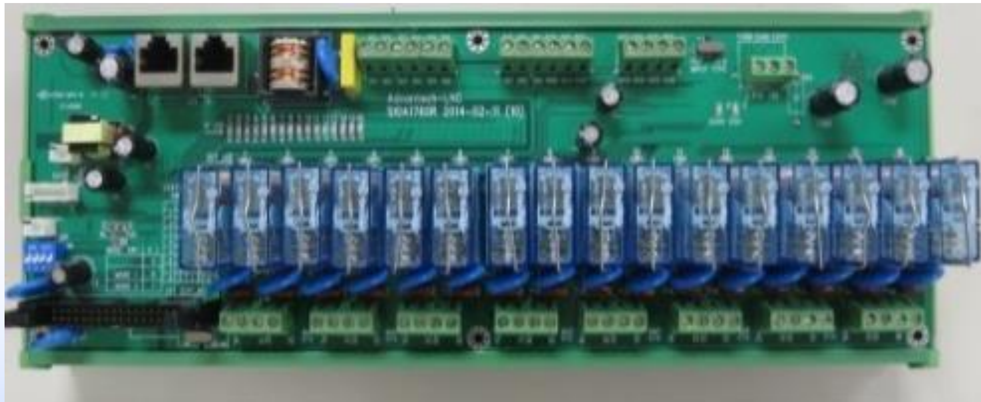
继电器I/O板(SIOA-1760) 输入：16点 输出：16点 最大扩充：8块IO板
