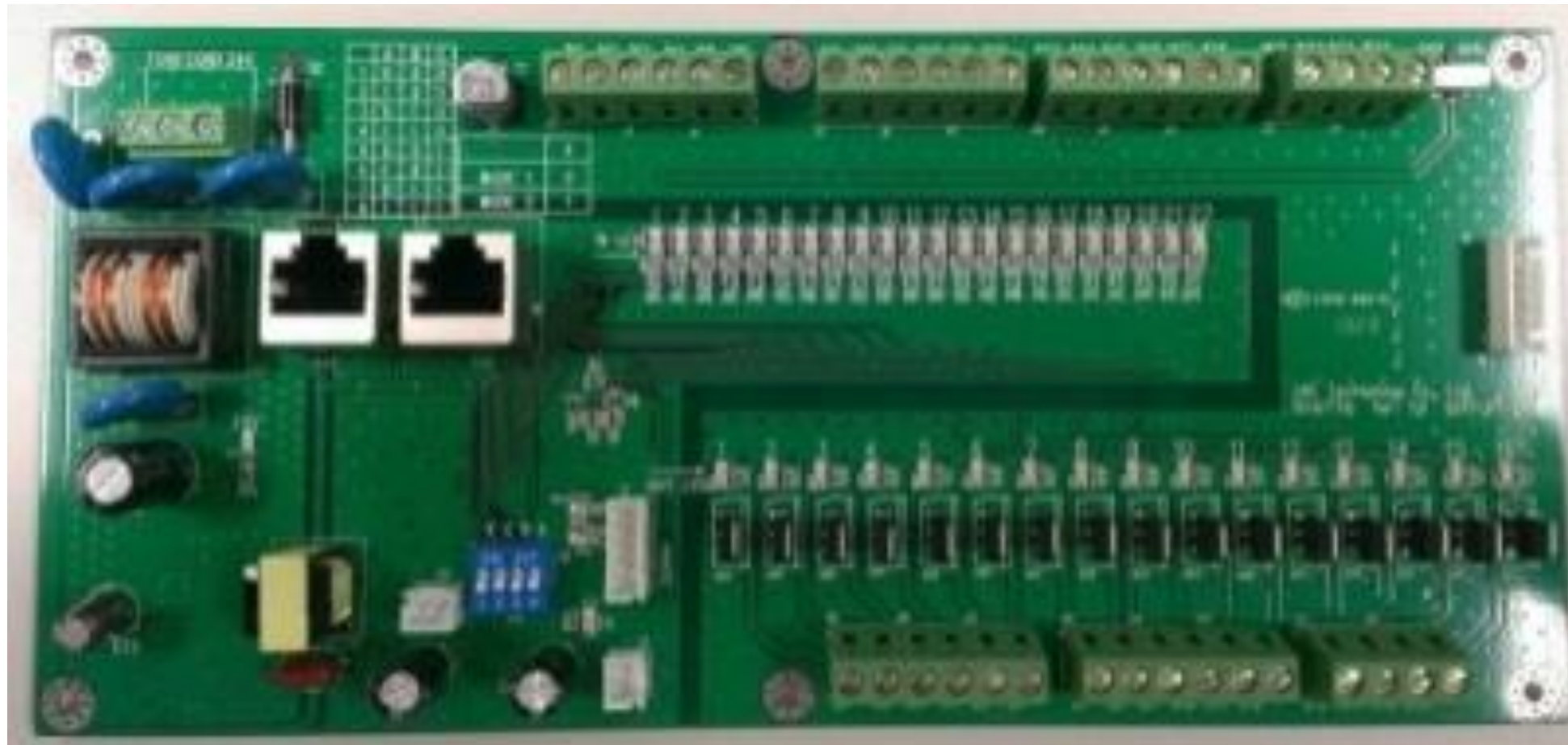
晶体式I/O板(SIOA-1700) 输入：22点 输出：16点 最大扩充：8块IO板
